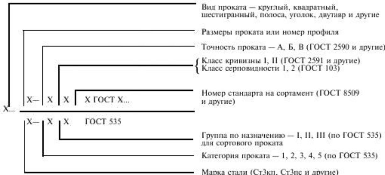
Прокат горячекатаный круглый диаметром 30 мм обычной точности прокатки (В), II класса кривизны, по ГОСТ 2590 марки Ст3сп, категории I, группы II:
